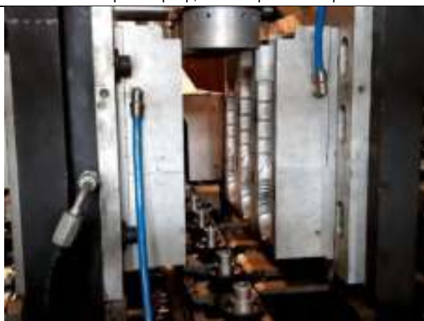
Пресс-формы 1,5 литра (3 гнезда), инвентарный номер 00-000045. Установлены внутри автомата фасовочно-упаковочного Инпак-Эконом с дозатором МВД-11.
